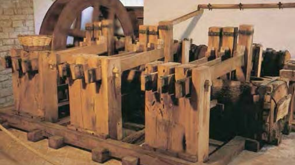
Pila idraulica a magli per sfilacciare gli stracci e produrre la pasta della carta, ricostruzione. Fabriano, Museo della carta e filigrana
